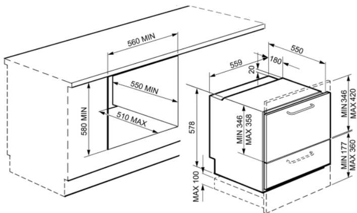
attenzione: dimensioni riferite ad installazione con pannelli di spessore 20 mm.
